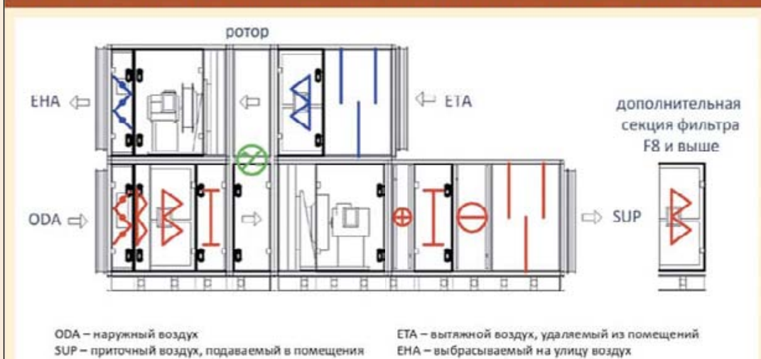
РИС. 3 СХЕМА ВЕНТИЛЯЦИИ С ИСПОЛЬЗОВАНИЕМ ВЫСОКОЭФФЕКТИВНЫХ РОТОРНЫХ РЕКУПЕРАТОРОВ
